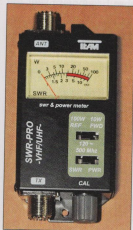
Bild 4: Ein solches, für UHF geeignetes SWV-Messgerät reicht zur Inbetriebnahme völlig aus.
